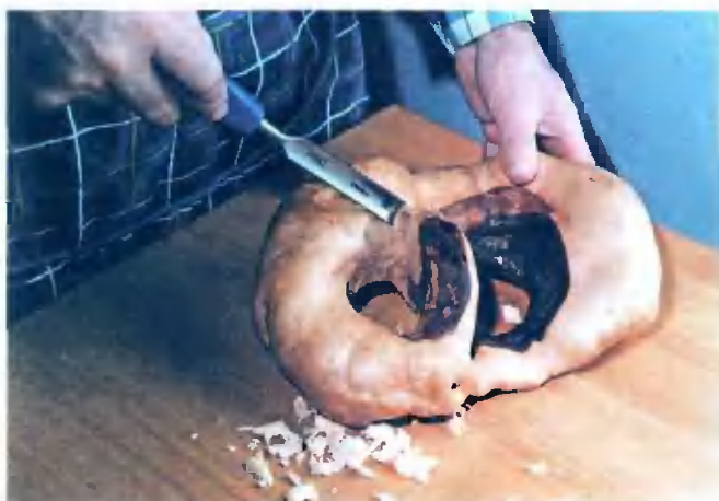
Чистовую обработку нароста (капа) производят хорошо заточенным инструментом.
