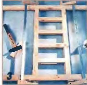
У фронтальной рамы сначала вклеивают детали для образования проемов под выдвижные ящики, затем вклеивают верхнюю и нижнюю детали обвязки и, наконец, — боковые обвязки.
