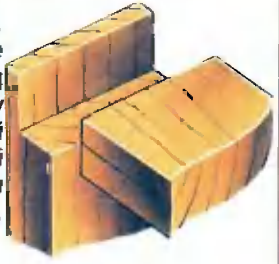
Рис. 5. Соединение в фальц между задней стенкой и корпусом мебели.
