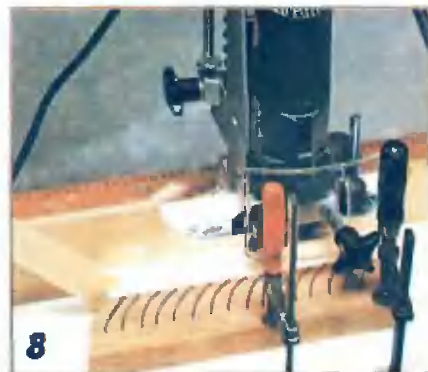
8 Направляющую в виде гребня закрепляют так, чтобы ее зубья плотно прижимали заготовку к продольному упору фрезерной машинки.
