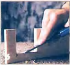
Вырез делают так. Сначала совершают два взаимно параллельных пропила, затем стамеской удаляют древесину между ними.
