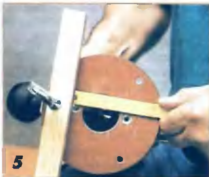
5 Достаточно эффективный упор: деревянная планка (отрезок доски, кусок ДСП или столярной плиты), прикрепленная струбциной к основанию фрезерной машинки.
