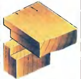
Рис. 7. Соединение в двойной фальц. Фальцами снабжены торцы обеих деталей.
