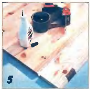
Боковую стенку и угловую доску со смежными узкими гранями, обрезанными под углом 22,5°, стягивают клейкой лентой так, чтобы их наружные кромки сходились вплотную. Стыки затем промазывают клеем и прижимают детали друг к другу.
