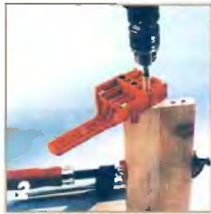
Такой кондуктор позволяет точно сверлить отверстия под нагели в торцах обвязок. При этом сразу несколько деталей можно зажать в пакет струбиной.
