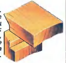
Рис. 6. Соединение в фальц и «на ус»: элегантно, но более сложно в исполнении.
