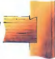
Рис. 4. Традиционное соединение в паз между стенками и полочными досками стеллажной мебели.
