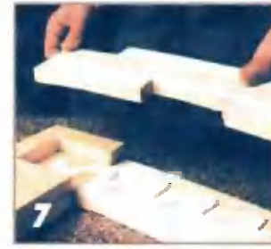
К наружным деталям E, K, M крепят средние слои деталей рамы и вертикальных связей.
