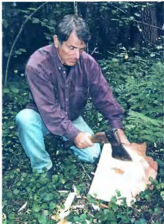
Лишнюю древесину целесообразно удалить на месте заготовки.
